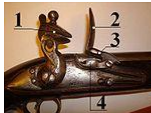
Platine à silex dit à la miquelet
